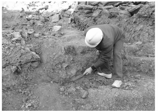
图2 剪断土体形成的滑带
