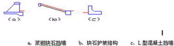
图1 原河道典型护坡结构形式
