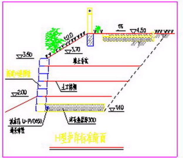
图2 护坡结构型式
