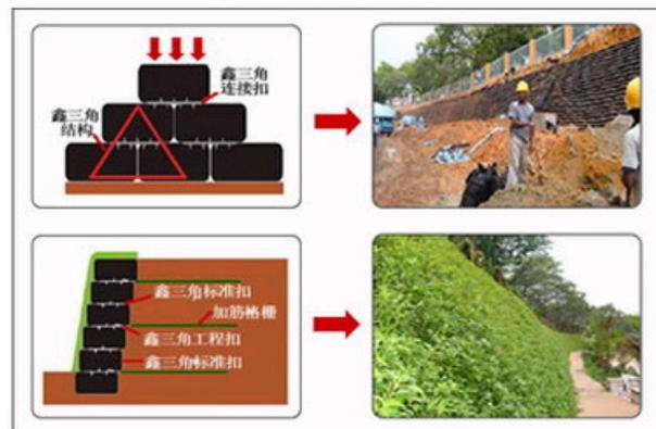
图5 生态环保工程系统护坡结构图
