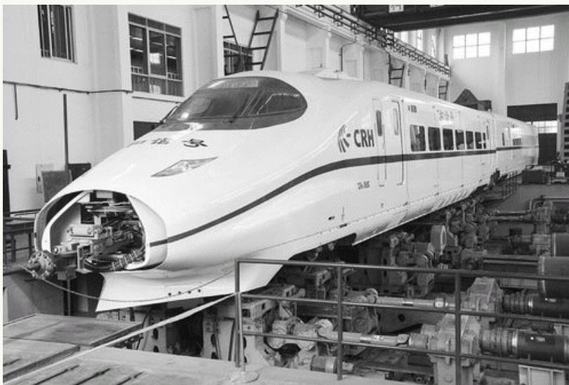
图为西南交通大学机车车辆整车滚动振动试验台。西南交大供图
