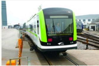
图为在试验线路上运行的“储能式电力牵引轻轨车辆”原型车。梁超摄
