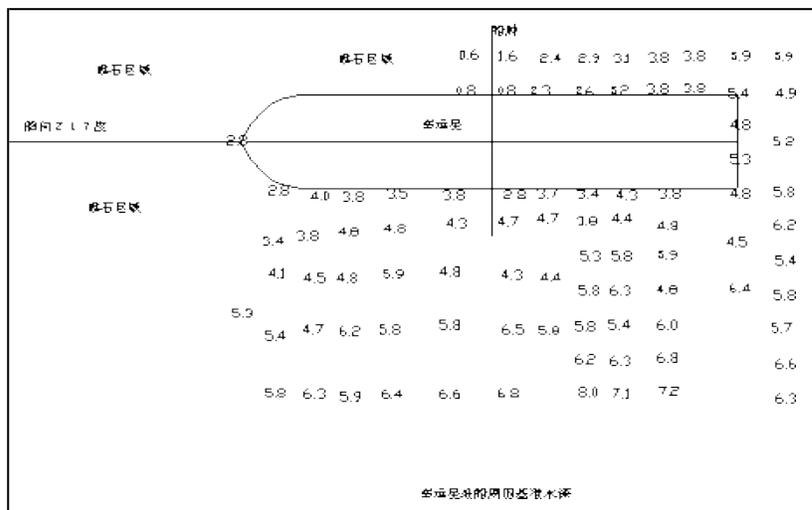
难船周围潮汐潮流变化，潮汐为规则的半日潮，潮流为往复流，方向为NW—SE向，大汛期间最大流速可达4.5节左右，小汛期间最大流速为3节左右。而且涌浪较大（涌浪由左舷上至右舷），涌浪作用造成难船艏部上下、左右摇摆的幅度较大。
