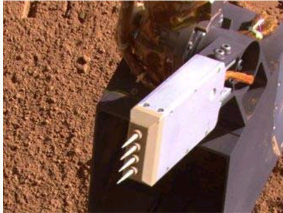
用来检测火星土壤导电性的探头
