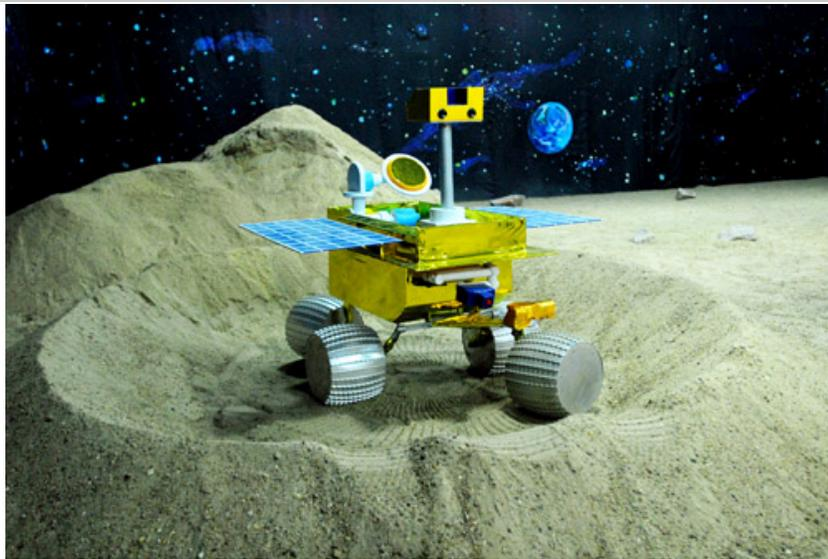
第四届中英空间科学与技术合作研讨会、中国宇航学会深空探测技术学术年会10月12日在长沙召开。会上传出一个激动人心的消息：我国“探月工程”中的月球探测车研制已经取得突破性进展，由“探月工程”重大专项教育部专家组组长、我校校长钟志华院士领衔的项目组，自主创新研制出的四轮三轴菱形布置月球车，通过月面相似环境等相关试验验证，其性能完全可以达到甚至超过国外六轮月球车相应的技术指标。
