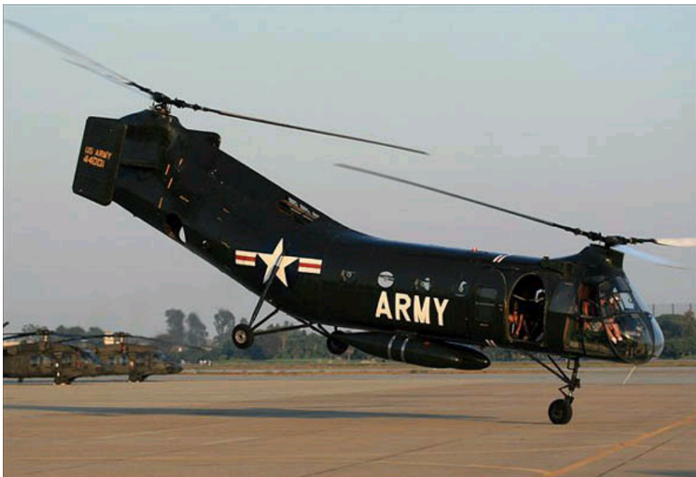
美国空军装备的纵列双悬翼式运输直升机CH-21 [资料图片]
