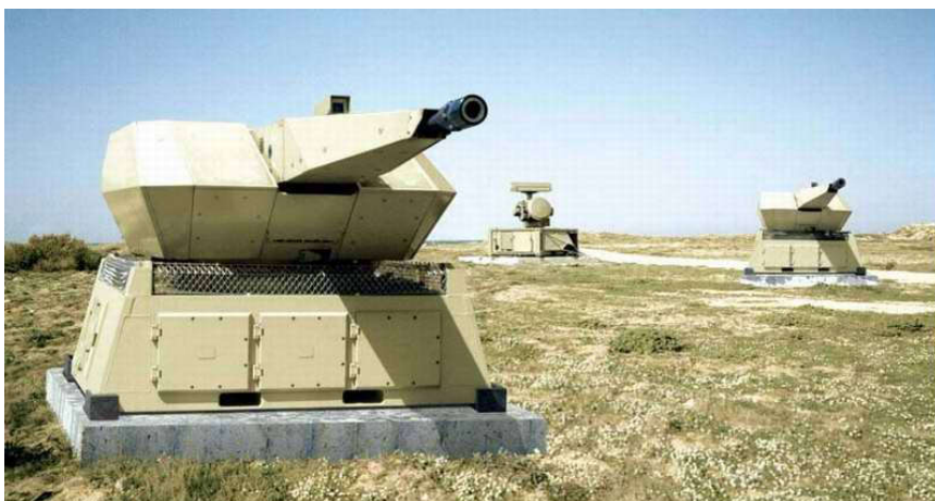
图为瑞士厄利孔公司的“天盾”防空系统，其主要由35mm火炮、火控监视系统、合成指挥控制系统组成。德国莱茵金属公司在其基础上改进为更加先进的C-RAM系统
