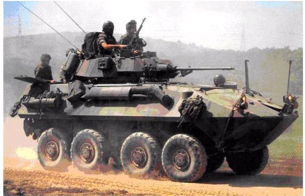
美军原来只有海军陆战队使用轮式装甲车，主要是加拿大生产的LAV-25(8×8)装甲运输车，共装备了758辆，其中包括96辆“陶”式反坦克导弹发射车。LAV-25装有1门25毫米机关炮，可搭载6名步兵，在攻占科威特城的战斗中发挥了重要作用。
