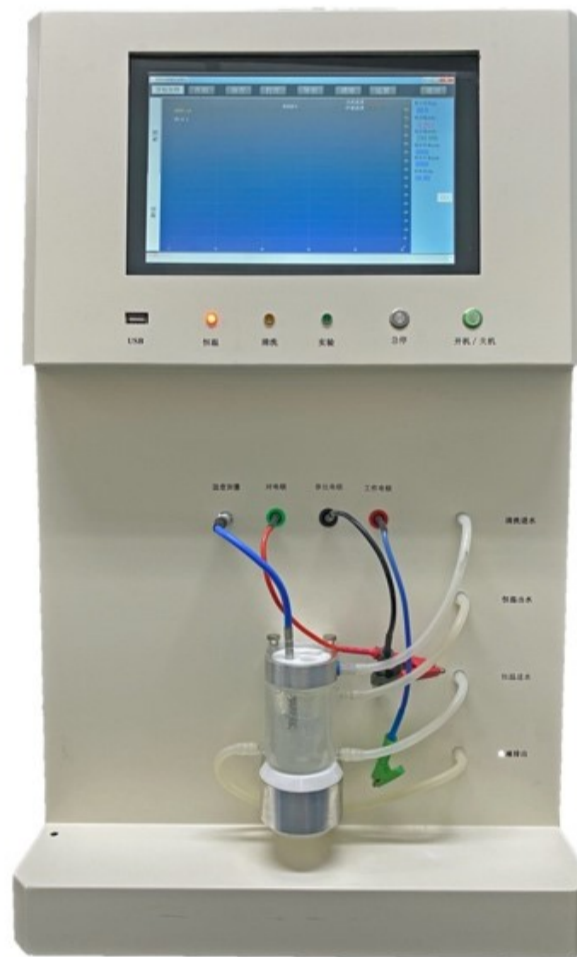
理化所研制出国内首台基于电化学原理的水质毒性检测设备Model ETOX-1801
