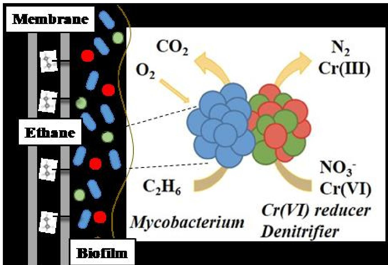
图1 乙烷驱动Cr(VI)/硝酸盐复合污染净化机制
