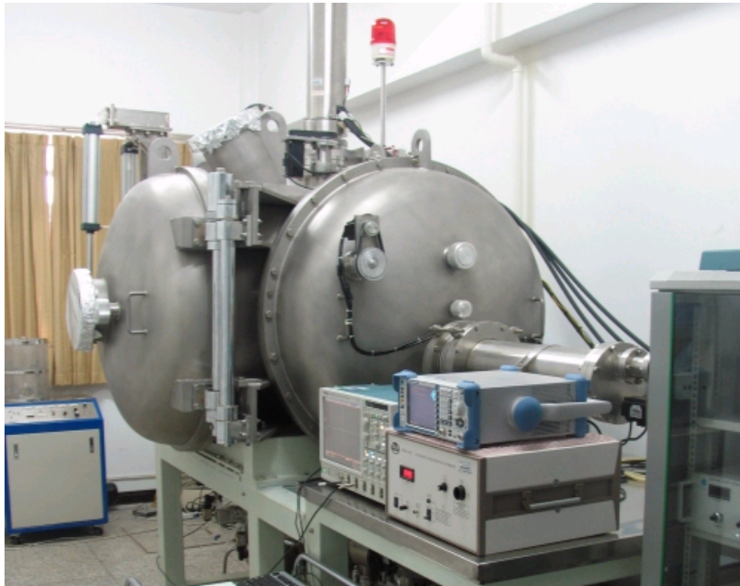
第二代卫星内部充放电模拟试验装置
