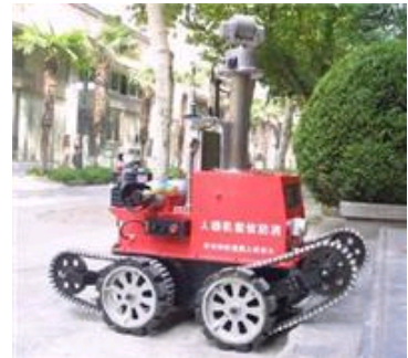
我所研发的“具有防爆特征的消防侦察机器人”获国家发明专利
