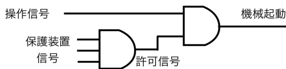
図2 インターロックの基本構造
