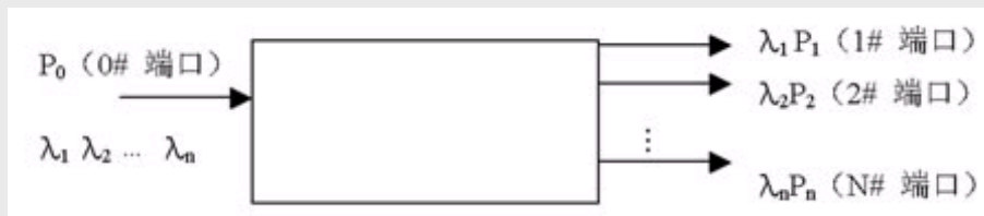
图1 WDM光传输原理图
