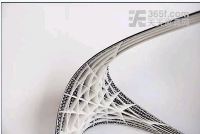
Gaudi椅由碳纤维材料经压缩制成，网格状的结构支持着弯曲的外壳。为实现所需的复杂程度，该椅的结构采用了快速成形工艺，之后再在经快速成形制成的结构上进行碳纤维材料的层压。这两种高科技的工艺过程降低了产品的制造成本，也使得最终成品的质量非常轻盈，一把Gaudi凳仅重1千克。
