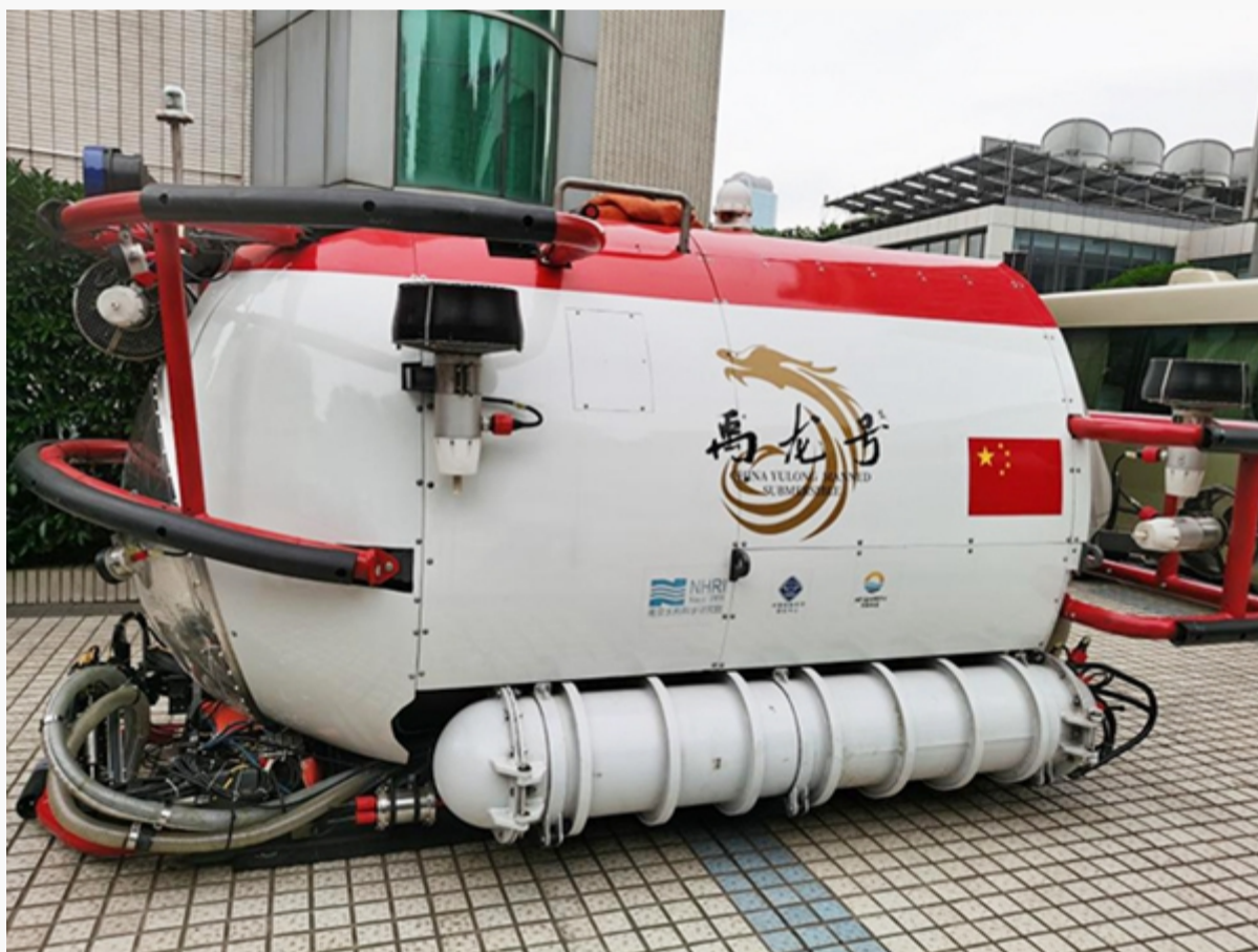
“禹龙”号大坝深水检测潜水器。水利部供图
