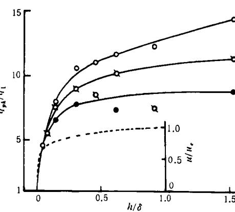
图 6 台阶高度对热流峰值的影响 ( $M_1 = 5.2$ )
