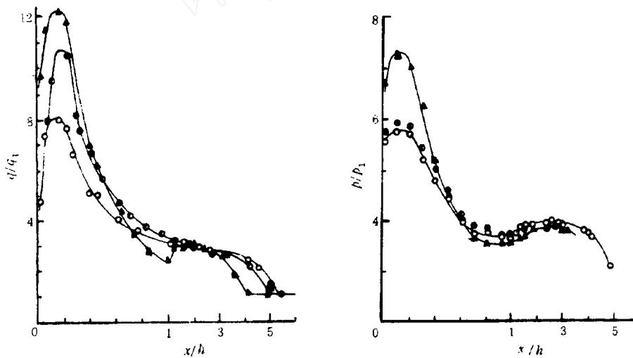
图 9 方柱台阶前热流和压力分布 ( $M_1 = 7.8, d = 6\text{cm}, h/\delta = 1.6$ )
