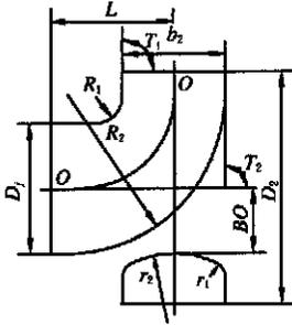
图 1 单流道叶轮轴面图
