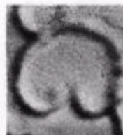
图 2 一个較完整的蝕綫。图面为 (0001) \times 2000
