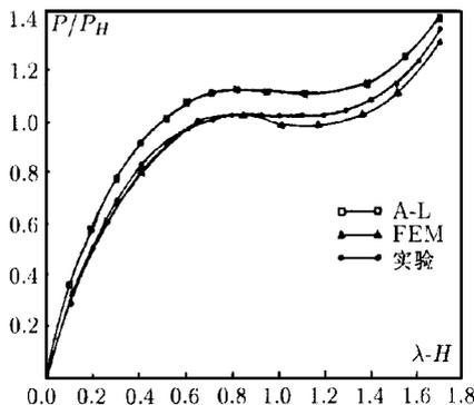
图 5 弱变化弹簧  $P_H = 562 \text{ kg}$
