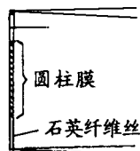
图5 圆柱形热膜敏感元件构造
