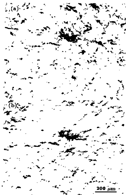
图 8 疲劳断裂后试样表面的长距离显微镜原位观察
