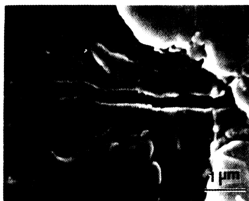
图 2 晶须架桥的 SEM 照片
