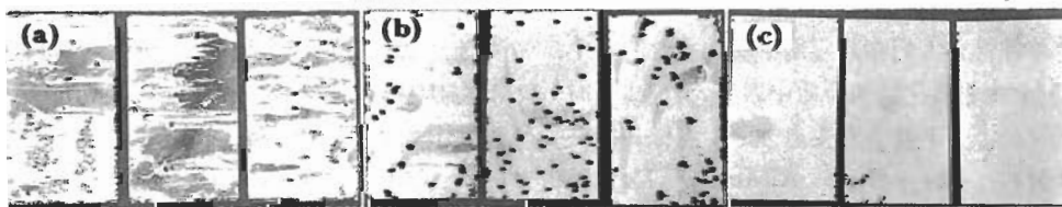
图 2 挤压 Mg 合金 AM60 在不同 pH 值的 3.5%NaCl 溶液中浸泡 6 h 的腐蚀形貌
