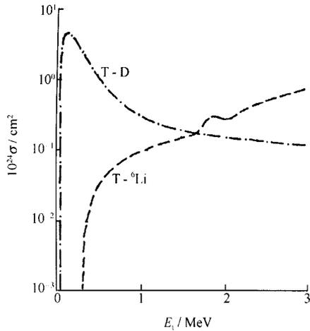
图3 D及 ${}^6\text{Li}$ 两核的(t,n)反应截面随氚核能量变化曲线
