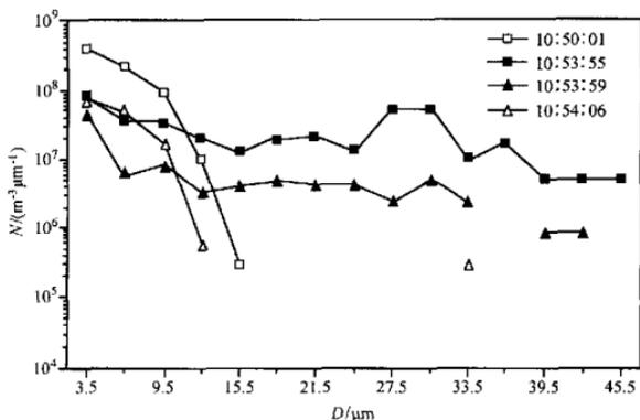
图7 作业前后 FSSP 粒子谱变化图
