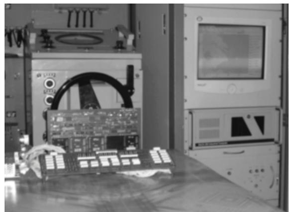
图 3 船舶航迹控制模拟系统
