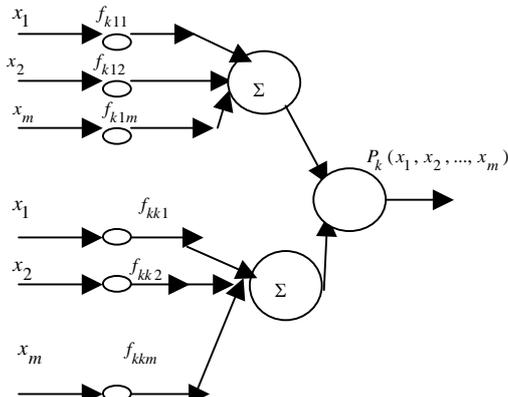
图4  $k$  块 Sigma-Pi 泛函网络结构
