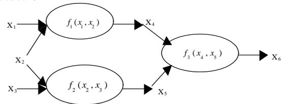
图 1 一个泛函网络结构模型
