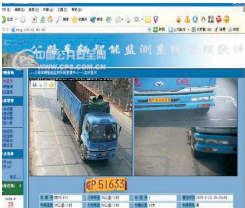
还可以从图像中发现工程施工质量和设备部件的性能情况等。在图3的右图中，可以发现摄像机与镜头不相匹配。
