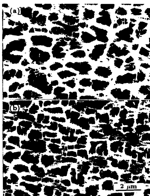
图 2 铸态 M963 合金中 \gamma' 析出相的形貌
