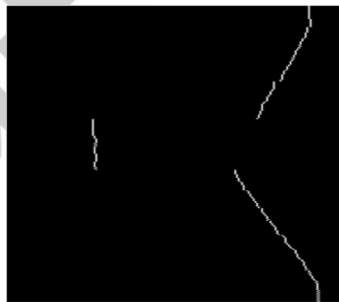
图 12 特征检测(激光带中心线提取)
