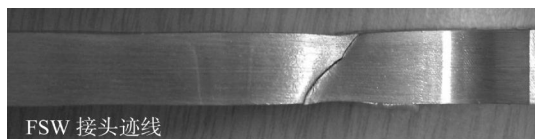
图 5 7A52 铝合金 FSW 接头拉伸试样断口
