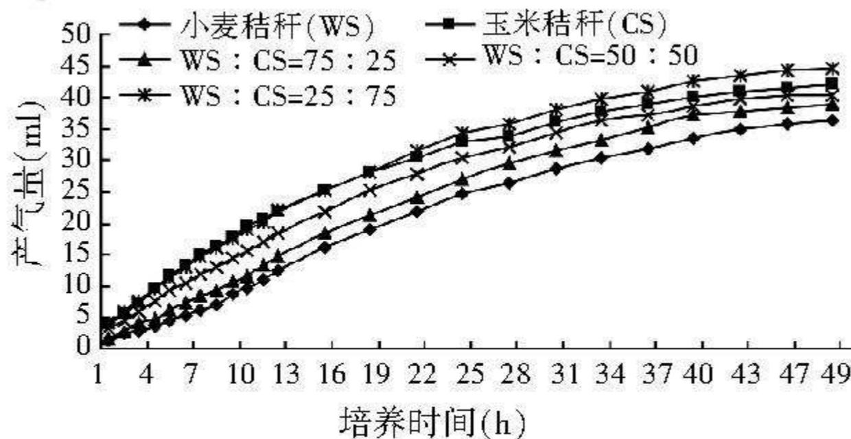
图3 小麦秸秆与玉米秸秆不同比例组合在不同发酵时间点的产气量
