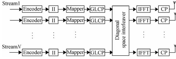
图 1 频率选择性衰落信道下 Turbo-BLAST 系统发射机
