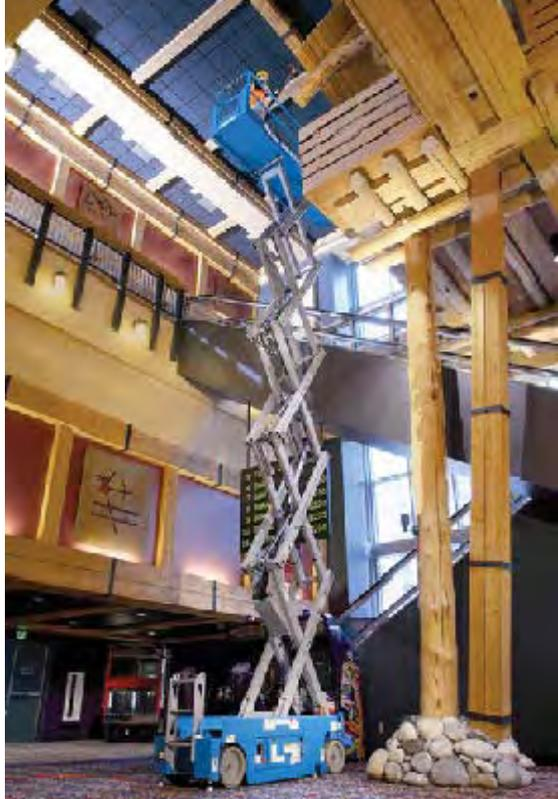
GS™ - 3232 具有标准的吉尼自动平衡液压支腿系统，可以在斜坡上进行 5° 侧面至侧面的水平调整和 3° 前面至后面的水平调整。该机还配备了吉尼 4 轮制动系统。
