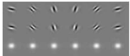
图 2 DT-CWT 的滤波脉冲频率响应
