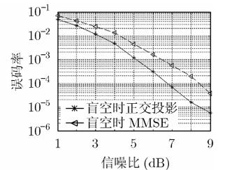
图3 不同检测方案的误码性能比较
