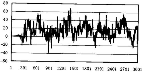
图3 用 RLS 辨识参数  $b_1$  的曲线图
