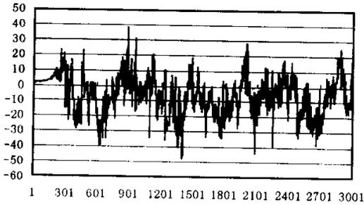
图1 用 RLS 辨识参数  $b_0$  的曲线图
