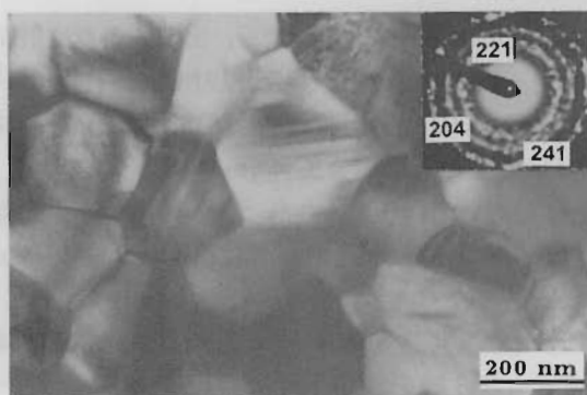
图 8 Cu 6 Sn 5 的 TEM 明场形貌及电子衍射图
