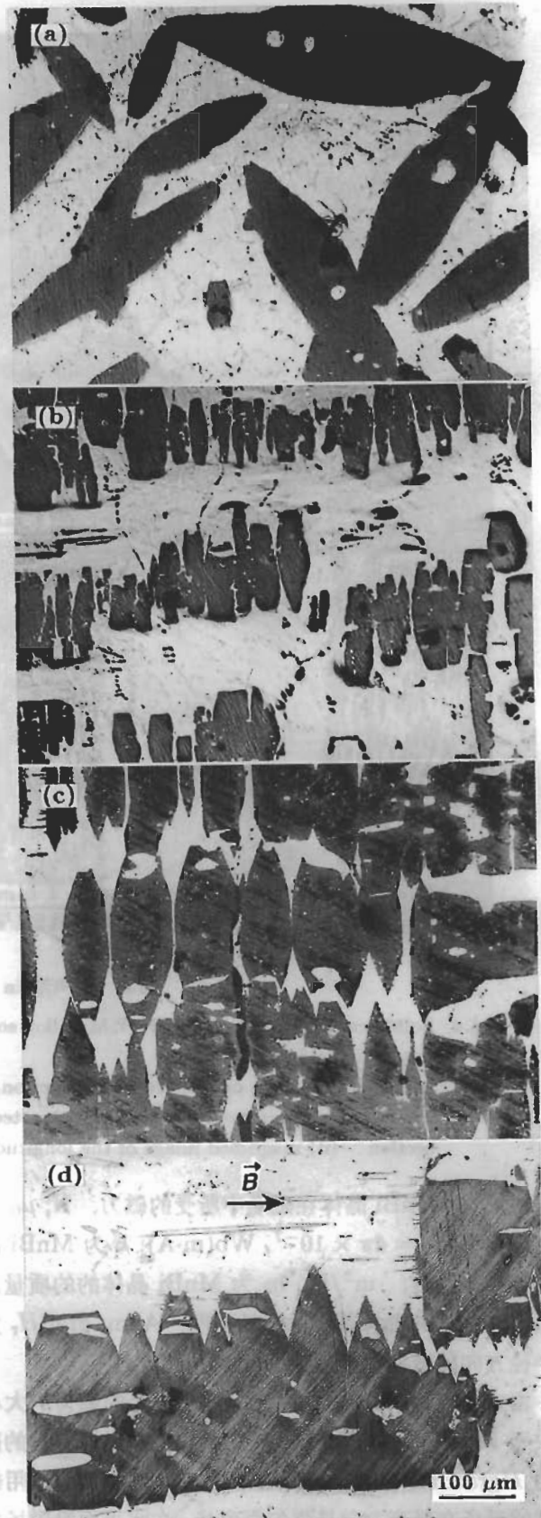
图 6 在不同条件下从 Curie 点以上开始凝固的 Bi-6%Mn 合金组织
