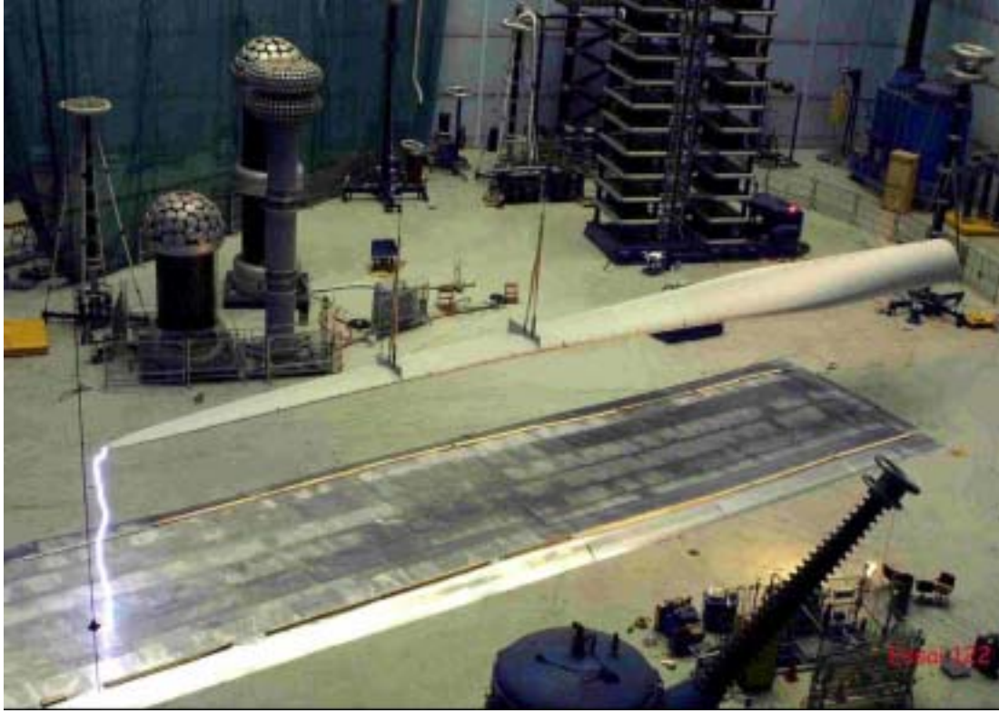
图 9：正脉冲（电弧电压为 1511KV 时间为 141 \mu s）
