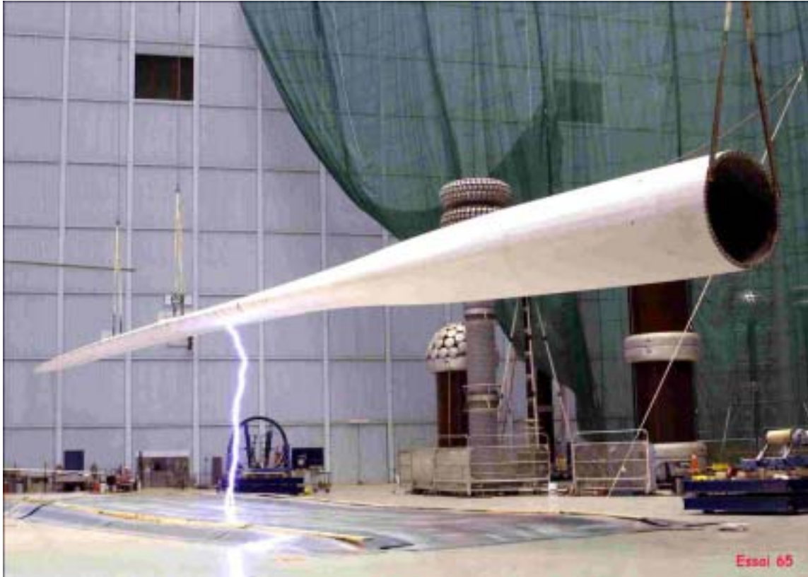
图 8: 脉冲 (电弧电压为 1484KV, 时间为 137\mu s )
