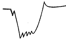
图6 二极管电容对波形的影响
