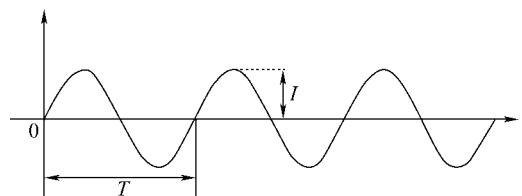
图3 连续正弦波电流波形
