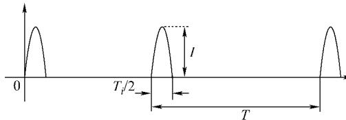
图2 单向正弦半波电流波形
