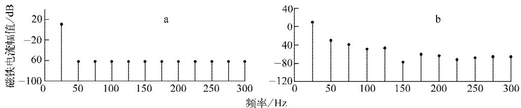
图4 不同激励源输入下磁铁电流的幅频特性图及THD含量
