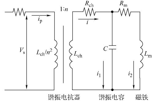
图1 单网孔并联型怀特电路
