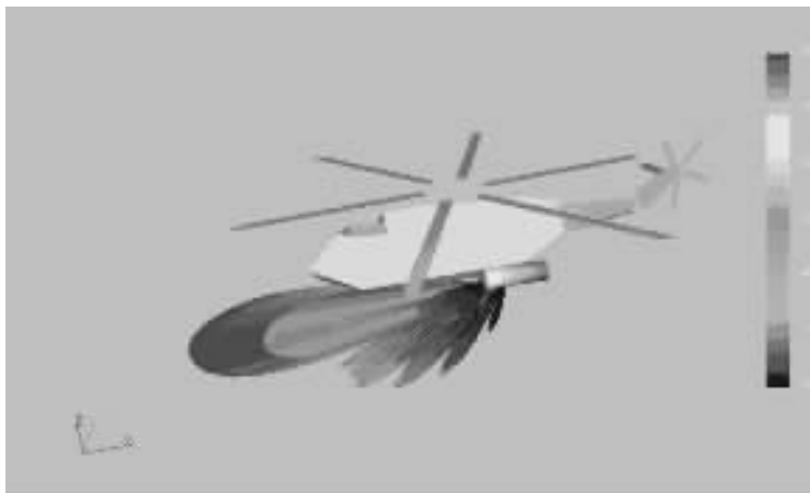
图 12 机载相控阵天线方向图
