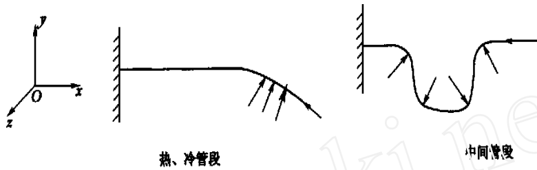
图2 破裂管道简化计算模型
