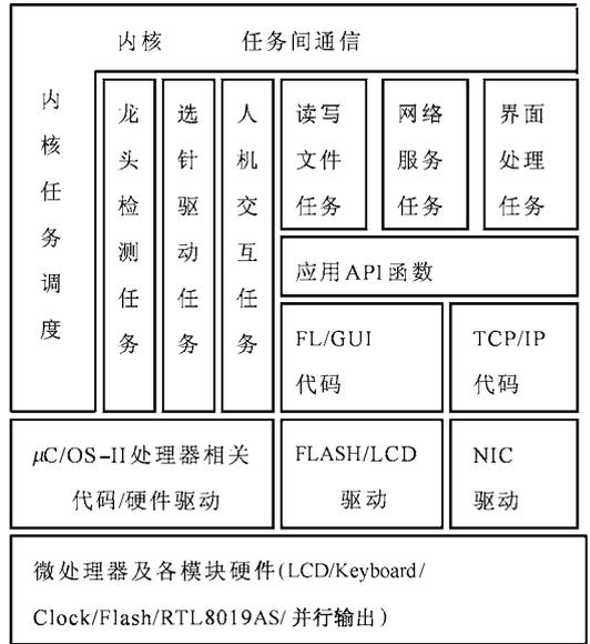
图 6  $\mu C/OS-II$  软件组织结构图
