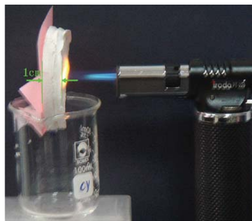
图 6 检测煅烧后的水玻璃为粘结剂的多孔 ZrO_2 块材的隔热耐火性能的实验照片
