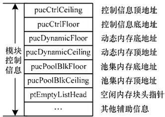
图2 模块控制信息结构
